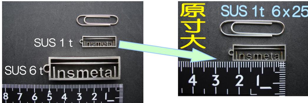
アマダレーザー加工機 F1(6kw)にて切断。
