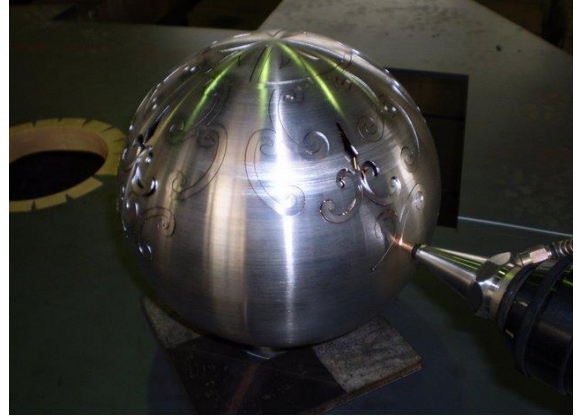
加工例1 SPCC 1.6t φ200 球体 クリーンカット
