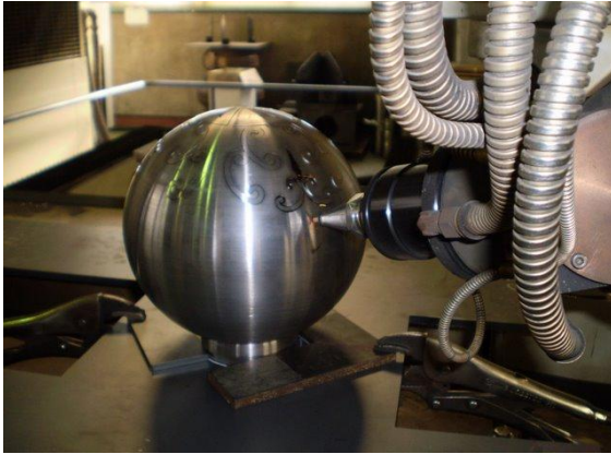
加工例1 SPCC 1.6t φ200 球体 クリーンカット
