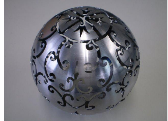
加工例2 SUS304丸パイプ 3.0t クリーンカット
