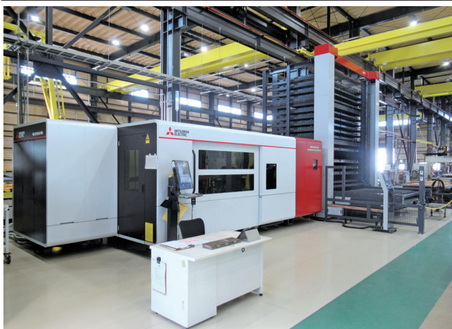
15段ストッカーと連動した8KWファイバーレーザー
