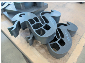
18KWレーザーでは40mm厚を安定切断
